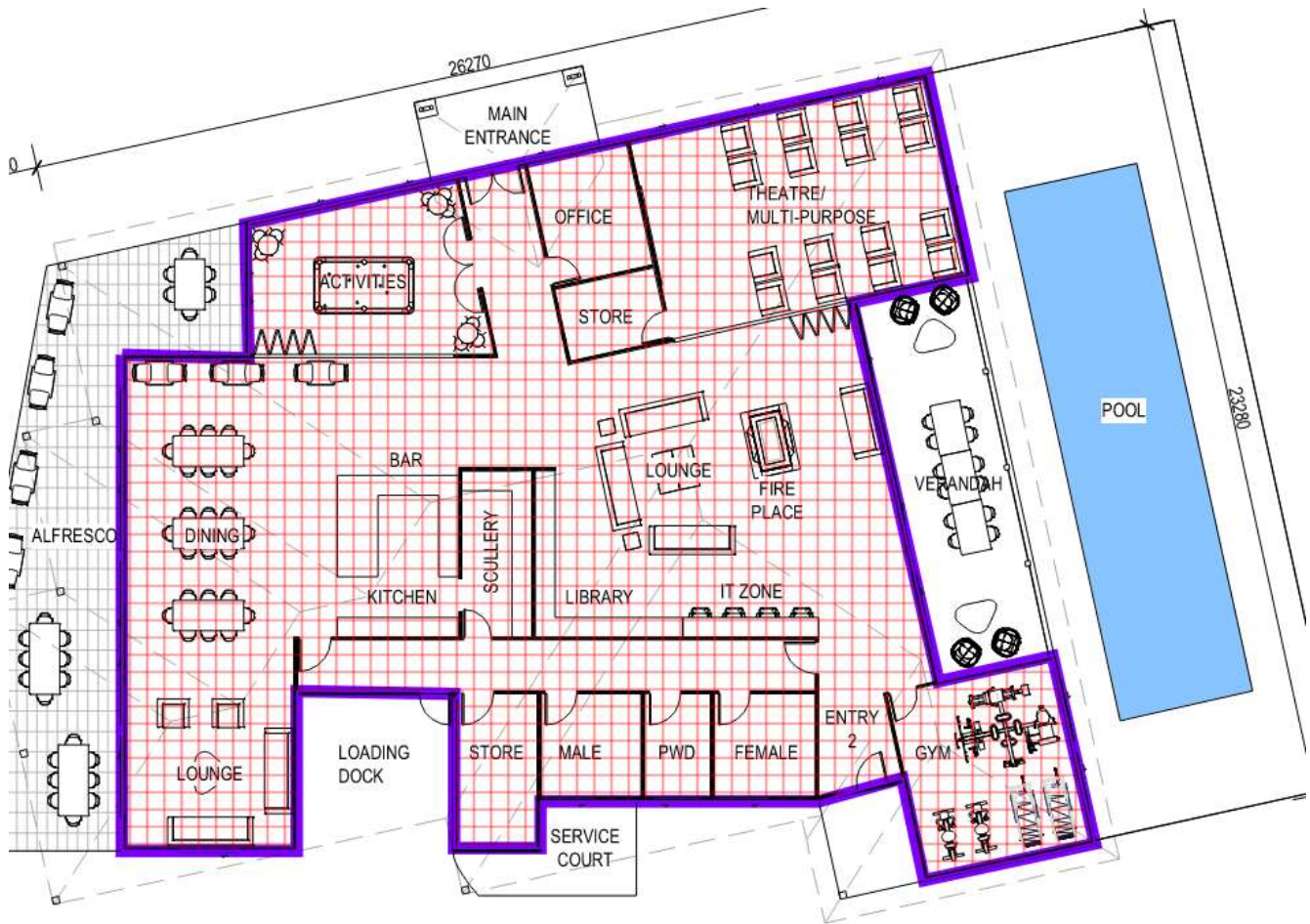
Figure 2 : Thermal envelop markup
